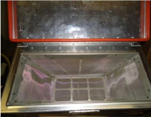
filtro de pantalla de pre de 300 micrones que recoge todas las partículas grandes y los atrapa para que el resto del aceite puede fluir dentro del tanque para ser filtrados.
