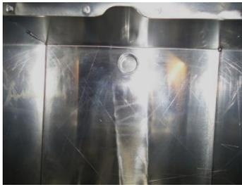
Antes de la almohadilla de filtro se coloca dentro del tanque. Observar dentro del tanque, centrándose en donde encaja el sello en el tanque.
