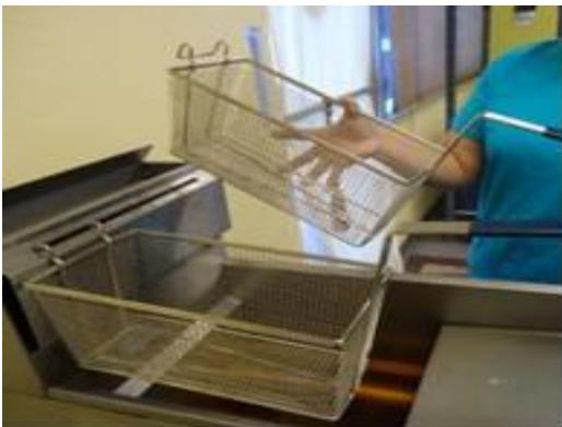
Retire las cestas de la freidora, así como las pantallas dentro de la freidora.
