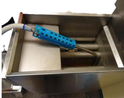
Como el Zeco<sup>®</sup> Eco esta filtrando el aceite, usar la vara para lavar hacia abajo la freidora entera, incluyendo los lados. Después de la hora deseada de la filtración, apague el Zeco<sup>®</sup> Eco girando el "aceite Out" interruptor en off. Cierre la válvula de la freidora. Gire el interruptor de "para bombiar el aceite" para el aceite de la bomba de vuelta en la freidora.
