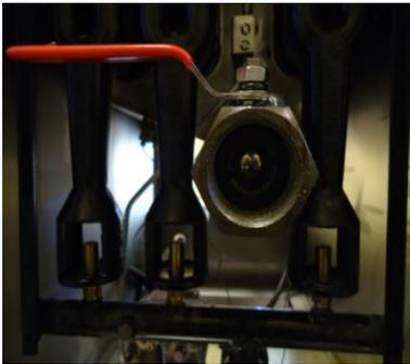
Esta la válvula en la freidora para drenar el aceite en el tanque del Zeco<sup>®</sup> Eco.
