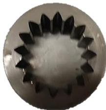
El anillo del engranaje externo dentro de la bomba es donde se puede comprobar si las partículas dañaron el equipo. Compruebe en el engranaje de los dientes para ver si ellos están oxidadas. Si ellos están oxidadas, tomar un fibra y friegue el interior del engranaje cuidadosamente.
