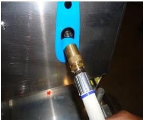
Conecte la manguera azul más larga a la válvula marcada por la pieza de plástico azul en la parte frontal de la unidad superior del Zeco<sup>®</sup> Eco.
