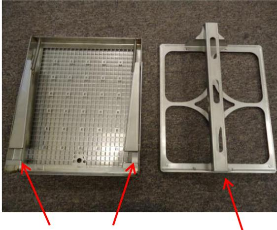
Para sacar la pantalla estos dos pestillos hasta que la encajen en su lugar hasta la pantalla puede deslizarse hacia fuera.
