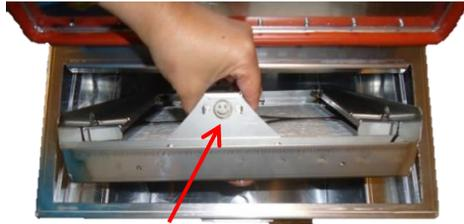
La forma correcta de poner el almohadilla filtro pan. La empaque "o" de Pan mostrando la cara sonriente mostrando la se coloca en la parte delantera del tanque.
