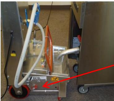
Para garantizar la seguridad, utilice la rueda de los frenos, que impide la Zeco<sup>®</sup> Eco moverse durante la filtración.
