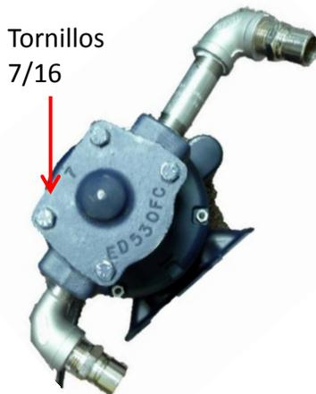
El eje de engranaje es lo que une el eje del engranaje y el engranaje. Después de quitar los pernos de la parte delantera de la tapa puede quitar el eje de engranaje e inspeccionar el interior de la Asamblea del engranaje por daños. Para lavar el equipo concentrador sólo lo enjuagar con agua y use una fibra para obtener las partículas fuera del plato.
