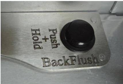
Botón "Volver al ras" "back flush" se utiliza para purgar los contaminantes del filtro en el tangué.
