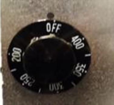
Indicador de temperatura dentro de la freidora. Cuando se este filtrando asegurarse que este girado para apagado o modo de piloto.
