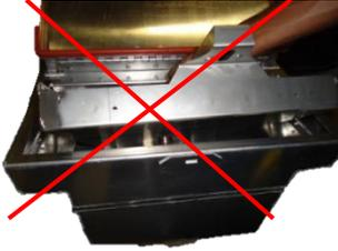
La forma incorrecta de colocar el filtro del cojín de la cacerola en. La parte larga de la manija siempre va a la parte posterior y la empaque "o" Pan siempre va al frente.
